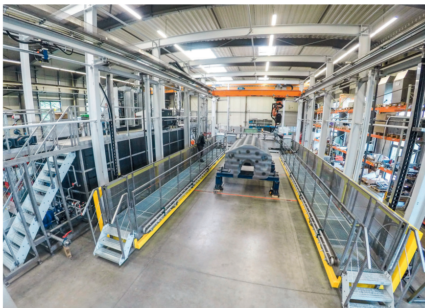
3 Die Anlage in der Frontalansicht: links der Technikraum mit Aufgang zum Leitstand und rechts der Nassbereich inklusive Arbeitsbühnen und Roboter © Purima
