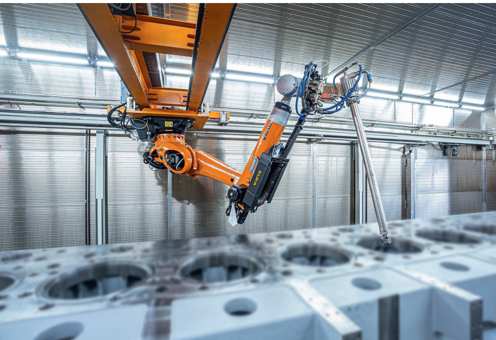
2 Nacheinander nimmt der Roboter Werkzeug für Werkzeug auf und führt die Feinreinigung durch, bei der Bearbeitungsrückstände zuverlässig entfernt werden © Purima
